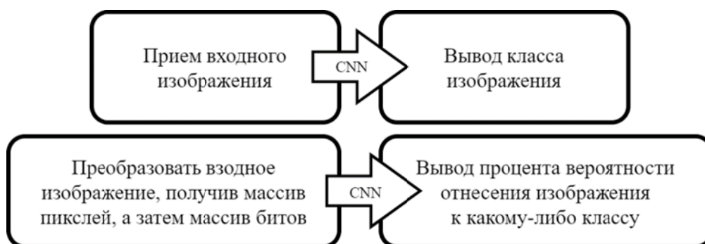
Рис. 1. Принципиальная схема решения задач классификации изображения с помощью сверточной нейронной сети
