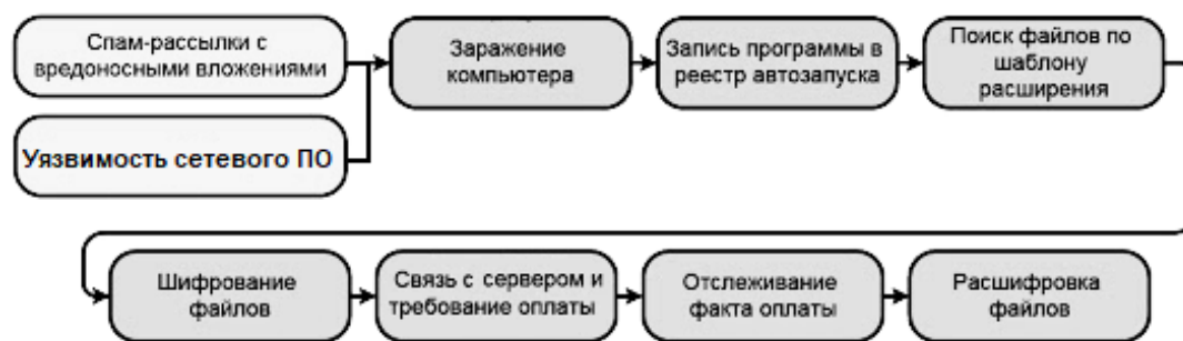
Рис. 4. Схема реализации внедрения вредоносного кода
