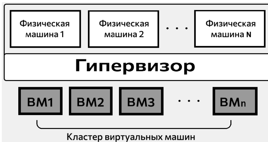
Рис. 2. Схема устройства технологии виртуализации
