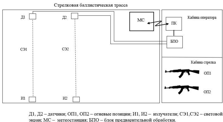
Рис. 1. Пример структурной схемы стрелковой баллистической измерительной установки
